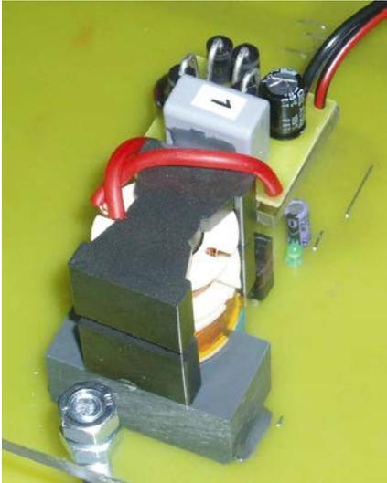
„Pick Up Core“ for a secondary unit.
